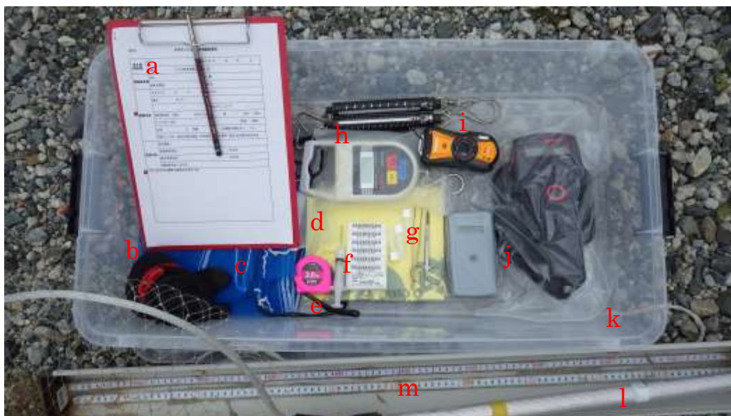
図3 オオサンショウウオの緊急保護グッズ。a)保護記録票、b)軍手、c)ネット袋、d)ビニル袋、e)メジャー、f)マイクロチップインプランター・マイクロチップ、g)はさみ・ピンセット・エタノール入りチューブ、h)はかり(上:バネばかり、下:電子ばかり)、i)防水カメラ、j)リーダー(右:AREH5、左:LID571)、k)衣装ケース、l)大型タモ網、m)全長測定器(裏面がシールのメジャーを樋に張って自作)。
